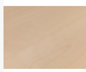
Buche gedämpft Flader, gestürzt Oberflächenstruktur Furnier
