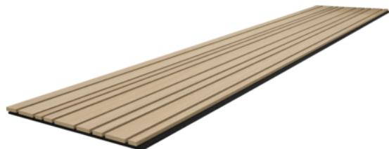
Die Akustik-Designpaneel bestehen aus einem Träger aus PET-Vlies mit echtfolzfurnierten MDF Lamellen. Die Oberfläche ist mit Hartwachs behandelt, wodurch das Holz optimal geschützt ist. Die Kanten sind leicht gefast. An der Rückseite der MDF Lamellen befindet sich ein Gegenzugpapier, das ein Verziehen der Lamellen verhindert.
