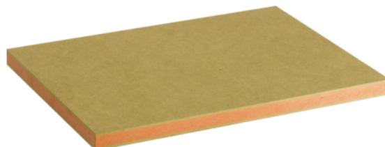
Die Fibrapan Hidrofugo Ignifugo E-Z ist eine MDF-Platte, die sowohl feuchtigkeitsbeständig als auch schwerentflammbar ist. Darüber hinaus weist die Platte eine sehr niedrige Formaldehydemission auf und ist daher E1E05 und CARB-2-zertifiziert. Die brandhemmenden Eigenschaften der Platte erfüllen die Anforderungen der europäischen Norm B-s1,d0. Die feuchtigkeitsbeständigen Eigenschaften entsprechen der Prüfungsnorm V313.
