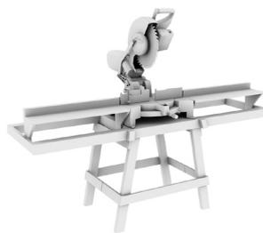
Radialsäge mit Holz-/Aluminium Mischblatt oder Kreissäge
