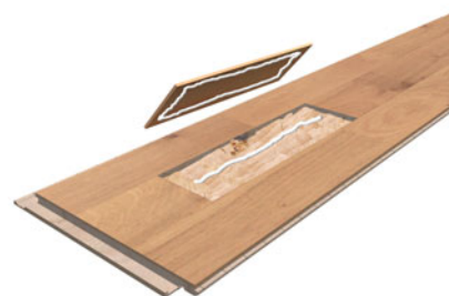
Ersatzstab auswählen und einpassen. Hohlraum mit Polyesterspachtel ausfüllen und Stab herunterdrücken.
