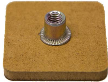
Abb. 4: FILKO Blindnietmutter (M8) mit kontrolliertem Deformationsbereich
