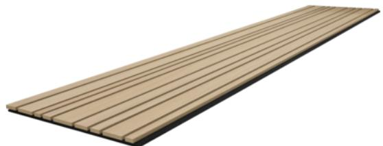
Die Akustik-Designpaneele bestehen aus einem Träger aus PET-Vlies mit echtfolzfurnierten MDF Lamellen. Die Oberfläche ist mit Hartwachs behandelt, wodurch das Holz optimal geschützt ist. Die Kanten sind leicht gefast. An der Rückseite der MDF Lamellen befindet sich ein Gegenzugpapier, das ein Verziehen der Lamellen verhindert.
