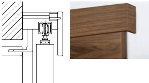
Schiebetürzarge für Einbaukasten
