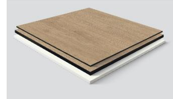
EGGER Kompaktplatten sind mehrschichtig aufgebaut und bestehen aus melaminharz imprägniertem Dekorpapier als Deckschicht und einer faserhaltigen, mit wärmehärtbaren Harzen gebundene Kernschicht.
